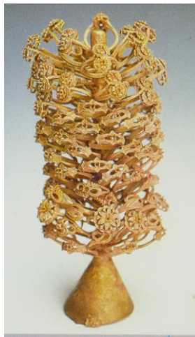
Рис.373. Восковой блок (а) и блок отливок (б)
