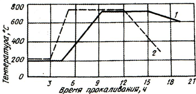
Рис.374. Режим прокаливания гипсодинасовых форм:
