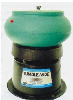
Рис.388. Виброгалтовка (а) и магнитогалтовка (б)
